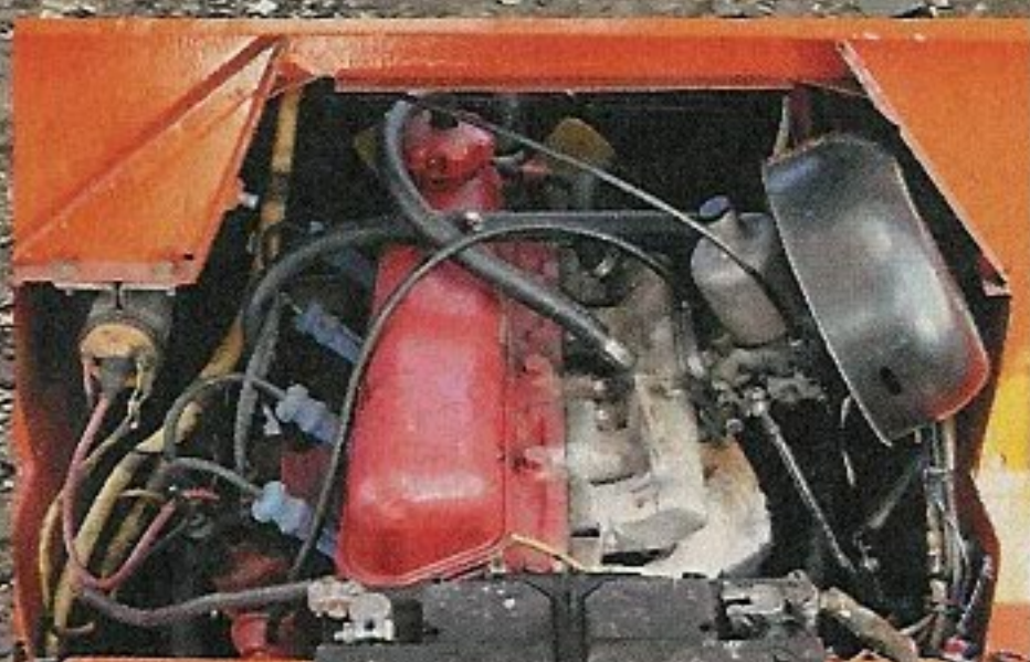
Grüße aus Amazonien: Der 82-PS-Einvergaser namens B20A ist Volvo-Fans ein alter Bekannter
