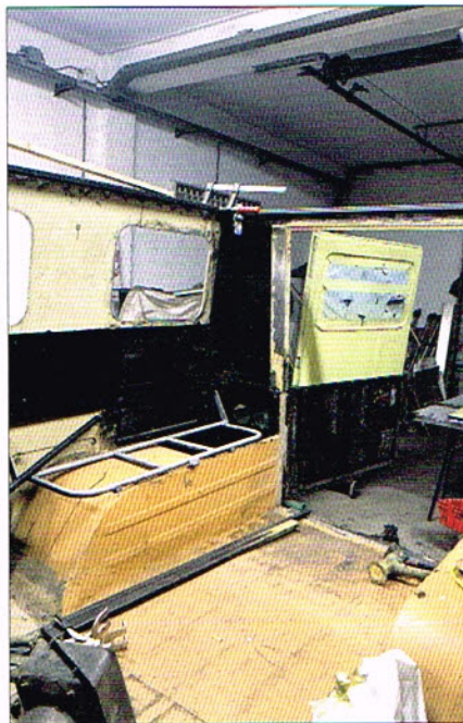
Verstevigingen maken voor het nieuwe hefdak. Tegelijk kunnen de dubbele wanden een tectylbehandeling krijgen
