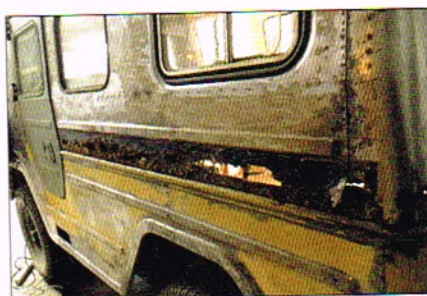
Roest heeft belangrijke delen van de carrosserie aangetast
