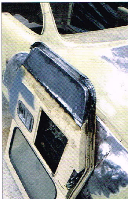
De onderkant van alle portieren is door de mannen geheel vernieuwd
