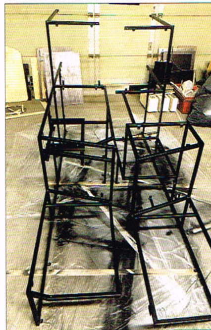
Buizenframe voor het nieuwe camperinterieur
