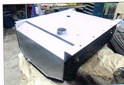
Handwerk - nieuwe brandstoftank met extra capaciteit
