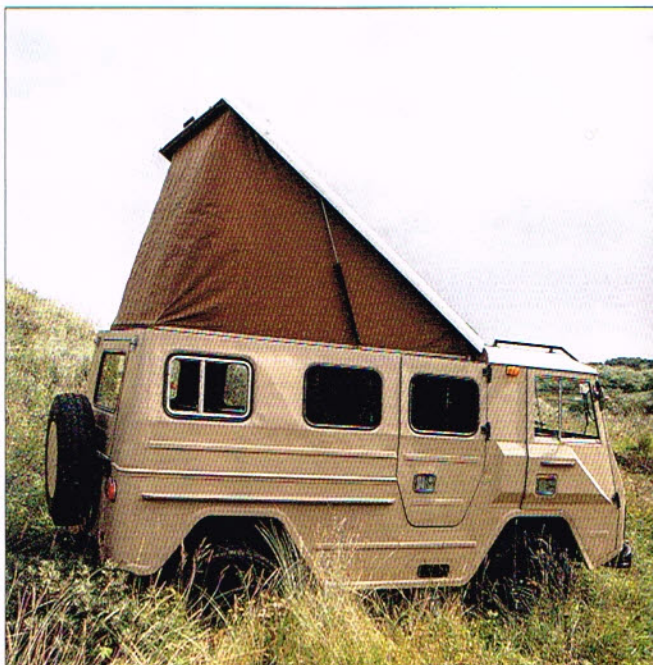
De grootste aanpassing op het origineel werd ingegeven door de nieuwe functie van de bus. Het vaste dak zou een hefdak moeten worden om de nodige slaapplekken te scheppen.
