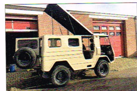
Eerste test van het nieuwe hefdak met gasveren
