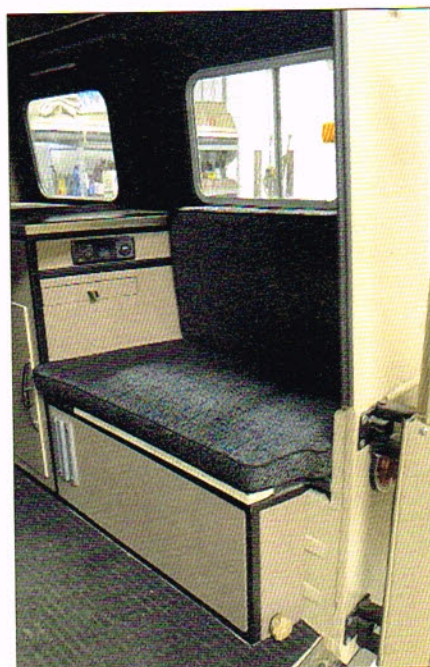
Kokerprofiel werd als basis gebruikt voor alle kastjes
