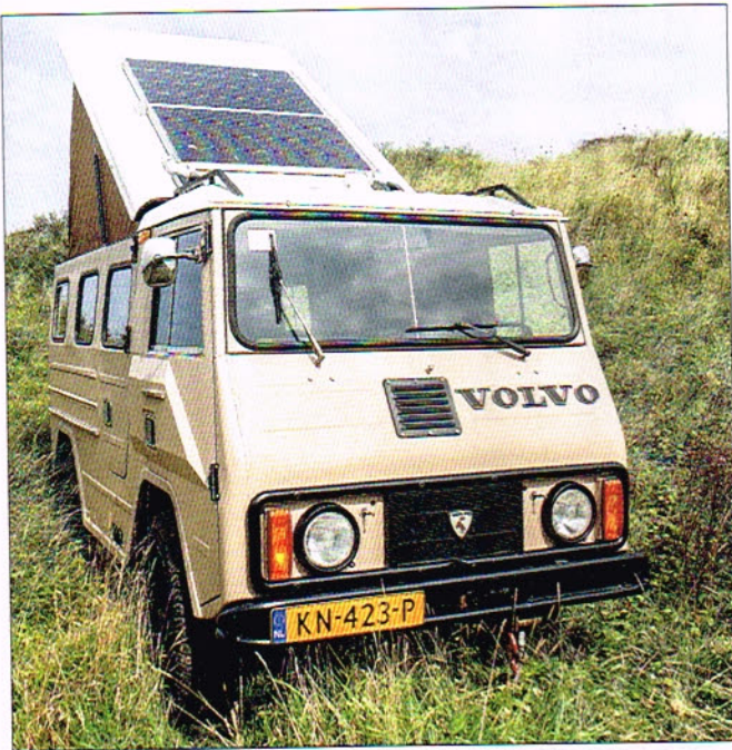
Met een paar sterke gasveren is het dak makkelijk te heffen. Zelfs als er nog zonnepanelen bovenop komen.
