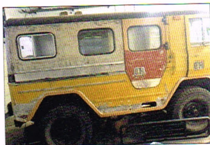
Een lapjessdeken van haastige reparaties uit het verleden wordt zichtbaar
