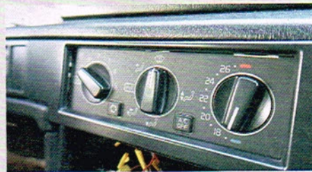
Die Lüftung ist an sich langlebig. Einzig schlecht gewartete Klimaanlage und leckende Heizungsventile machen immer wieder Probleme
