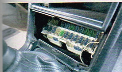
Kupferwurm adé: Der Sicherungskasten versteckt sich gut geschützt hinter der Mittelkonsole. Die gesamte Bordelektrik ist stabil
