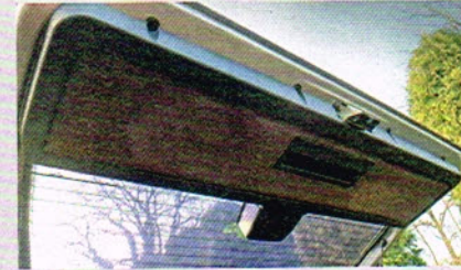
Nervig: Beim Kombi sind oft die Innenverkleidungen der Heckklappe total zerschossen oder ihre Halter reihenweise gebrochen
