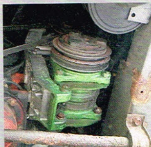
Oft defekt: unzureichend gewartete Klimaanlagekompressoren
