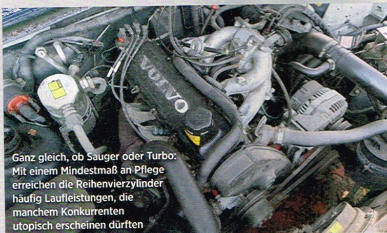
Alle 100.000 Kilometer oder zehn Jahre steht der Zahnriemenwechsel an. 2,3er (außer 16V) sind Freiläufer
