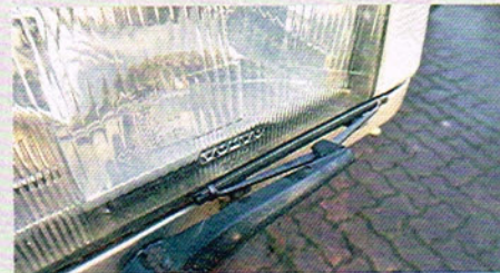
TÜV-relevant: Recht häufig streiken die Motoren der Scheinwerferreinigungsanlage, wenn sie nur selten benutzt worden ist
