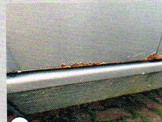
6 Selten: An der Unterkante der Kotflügel kann es durch Schmutz und Steinschlag rosten
