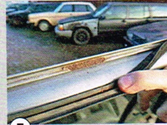
7 Versteckt: Unter den Gummis der Türoberkanten sammelt sich Feuchtigkeit und nährt den Gilb
