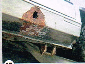
13 Eher die Ausnahme: Meist gammeln die Schweller Richtung Ende durch Spritzwasser und Dreck
