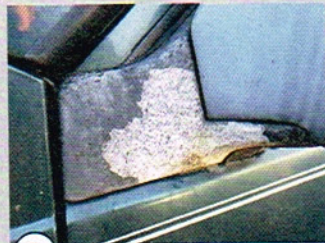
3 Bei Autos ohne trockenen Stellplatz korrodieren des Öffner die Ausleger der Außenspiegel
