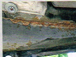
11 Halb so wild: Kantenrost am Unterboden findet sich oft, ist aber in der Regel leicht zu stoppen
