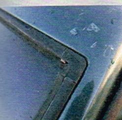
1 Gezerrt: der Windschutzscheibenrahmen. Metalllacke leiden unter Klarlackplatzern
