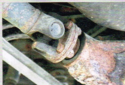
Die robuste Starrachse verliert am Eingang über den Simmerring gerne Flüssigkeit. Oft verschlissen: das Kardanwellenmittellager
