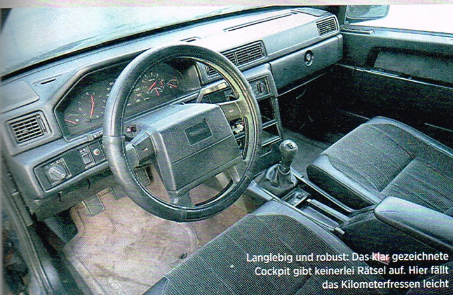
Lordosenstützen und Sitzheizungen fallen öfter aus. Erstere lassen sich gut reparieren, Letztere nur mit größerem Aufwand
