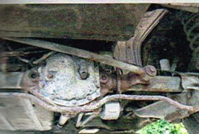
Im Gegensatz zum deutlich komplexeren 960 mit Multilenker-Hinterachse steckt im 940 eine unzerstörbare Starrachse
