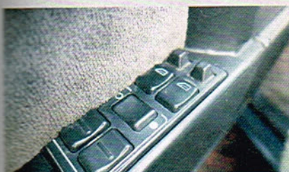
Schalter der Komfortausstattung sind selten ein Ärgernis. Reinigen und mit Kontaktspray behandeln reicht oft schon aus
