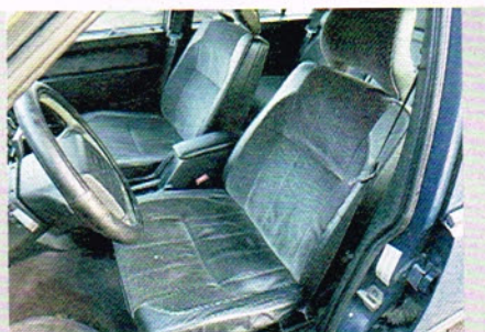
Lordosenstützen und Sitzheizungen fallen öfter aus. Erstere lassen sich gut reparieren, Letztere nur mit größerem Aufwand
