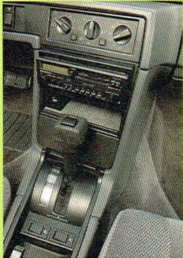
Die Automatikgetriebe gelten als ausgereift. Häufiger Anhängerbetrieb und verschleppte Wartungsarbeiten setzen ihnen zu
