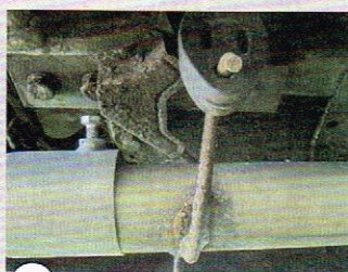
2 Einziger Auspuffknackpunkt ist die abrostende Aufhängung des Endtopfes. Skandix hat ein schraubbares Reparatur-Kit im Sortiment
