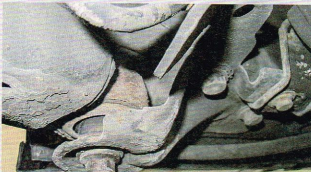
Die Bremsanlage zeigt sich im Großen und Ganzen unauffällig. Lediglich die kleinen Backen der Parkbremse sind meist noch die ersten und dementsprechend runter
