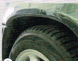
3 Blühen die Radläufe, ist nicht Volvo schuld, sondern eine unsachgerechte Unfallinstandsetzung
