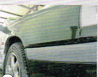
7 Verschlissene Exemplare weisen gelegentlich Durchrostungen am Kotflügel auf
