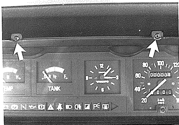
Alleen voor linker bedieningskabel: combi-instrument verwijderen Zie pagina 136, V18.
