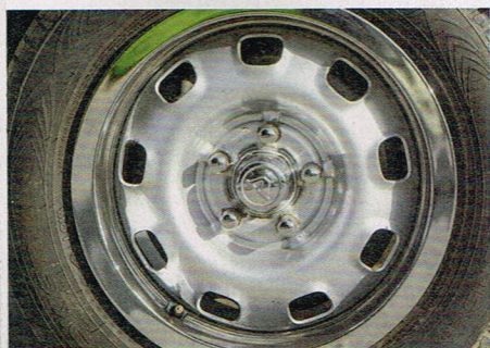
5x15 Stahlräder waren ab 1971 Serie, den Lochkreis 5x108 behielt Volvo noch ewig, sodass auch viele jüngere Aluräder passen
