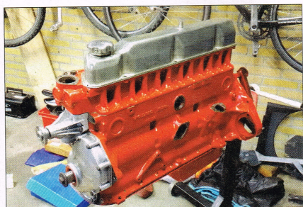
De motor werd helemaal gedemonteerd en gereviseerd door een specialist
